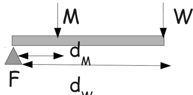
In ogni caso il momento e' zero se  $Md_M = Wd_w$  da cui si ricava:  $M = d_w/d_M W$ , la forza da applicare per sostenere il peso  $W$
